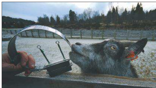
Prototypen: Klave dyret skal ha rundt halsen, drive av solceller.
